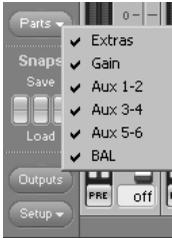
Um das Aussehen des Mixers noch weiter anzupassen, besteht unter „Parts“ die Möglichkeit, einzelne Zeilen von Steuerelementen des Mixers ein- oder auszublenden. Dies betrifft die Zeilen „Extras“ und alle Gain-, Aux- oder Bal-Regler. Außerdem kann das Fenster auch horizontal in der Größe verändert werden.
