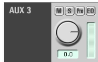
32. Il s'agit ici d'un gain numérique – vous ne pouvez donc pas résorber un gain qui résulterait d'une préamplification analogique par exemple.
